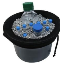
รูปที่ 2.9 ตัวอย่างตัวดูดซับสารเคมีและวัสดุกันกระแทก ที่ใช้ในการกั้นระหว่างขูดสารเคมีขณะเคลื่อนย้าย
