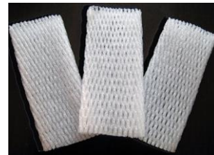
รูปที่ 2.9 ตัวอย่างตัวดูดซับสารเคมีและวัสดุกันกระแทก ที่ใช้ในการกั้นระหว่างขูดสารเคมีขณะเคลื่อนย้าย
